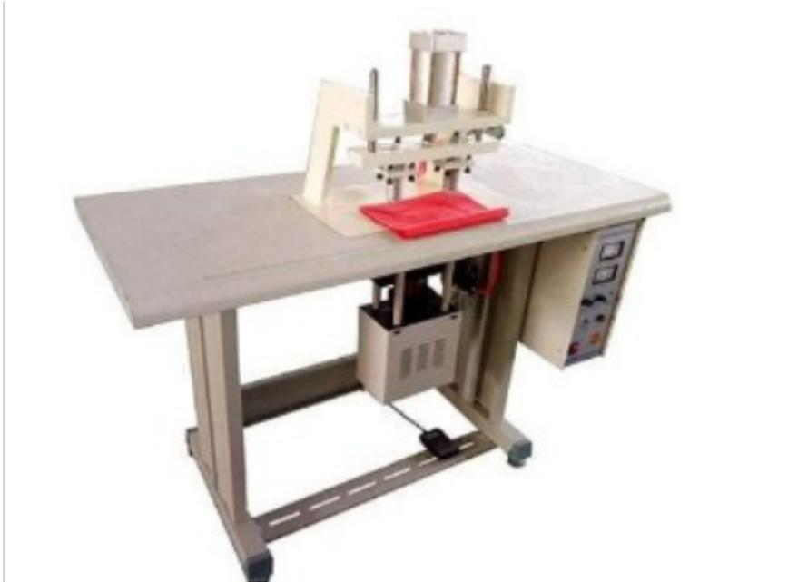
本实用新型涉及一种制袋机，具体涉及一种用于制作无纺布袋的制袋机。背景技术：无纺布袋具有环保实用的特点，近年来得到大力推广和使用，从而促使无纺布制袋成型技术快速发展。现有无纺布袋是通过无纺布袋成型机加工成型，在成型完成后，通过袋体脱膜装置将袋体从成型模具上脱离；袋子脱离后，由人工收集，然后放入到一个的袋体折叠机里面进行袋子折叠，袋子折叠后形成扁平状，然后装入包装箱内。由于袋体脱膜装置与袋体折叠机是两个\*\*的装置，因此还需要人工取袋与放袋，生产效率低，人工成本高□pe袋制袋机供应无纺布制袋机超声波粘合技术.
