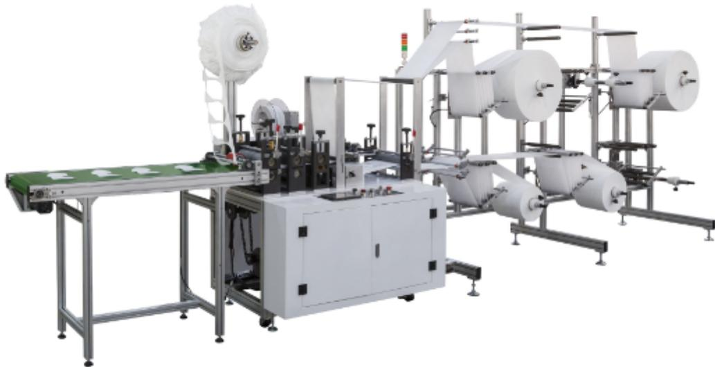
立体烫把无纺布制袋机为国内目前先进的设备，此机在制袋的时候自动焊上手提把，烫把速度高达30-75个/分钟，相当于5台烫把机，5个工人的烫把速度，能生产手提袋，平口袋、背心袋、穿绳袋等，已普遍用于服装，鞋类、酒类、礼品业等包装，很大减少人工，降\*\*造成本，代替了传统的手工缝纫袋，正\*\*于全国各地！性能及特点：立体烫把无纺布制袋机适用原材料为无纺布，能加工各种不同规格，不同形状的无纺布袋，平口袋、手提平口袋、背心袋、穿绳袋、无纺布立体袋、超市购物袋等，该机集机电为一体，运用LCD触摸屏操作，配以步进布式定长，光电跟踪，电脑自动定位，电脑自动纠边，准确、平稳、自定计数，即可设定记数报警，自动打孔，自动烫把手等工控装置，使其生产的成品封线牢固，切线美观，有效速，是你可以放心使用的质量环保型制袋设备。工序流程：卷筒料折边—穿绳—热合对折插边定位——打孔—热合切断收集成品。
